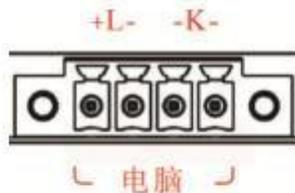
左边两个端子接电脑主机的开关指示灯，左正右负。
