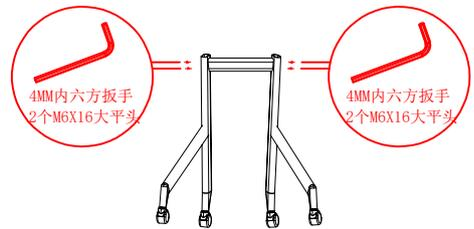
1. 红色线位置由外侧通过圆孔拧入共4颗内六角螺丝。(螺丝不要拧紧，配合下一步后再拧紧，摆放方向按图示)
