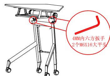
1. 最后将安装好的桌板翻转器总成与桌腿连接，按图示位置共4出螺丝。
