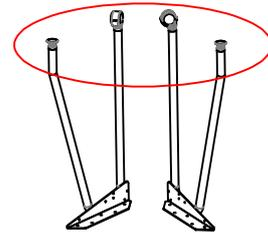
1. 桌腿底部用橡胶锤之类工具安装塑料内塞。(注意图示安装位置)
